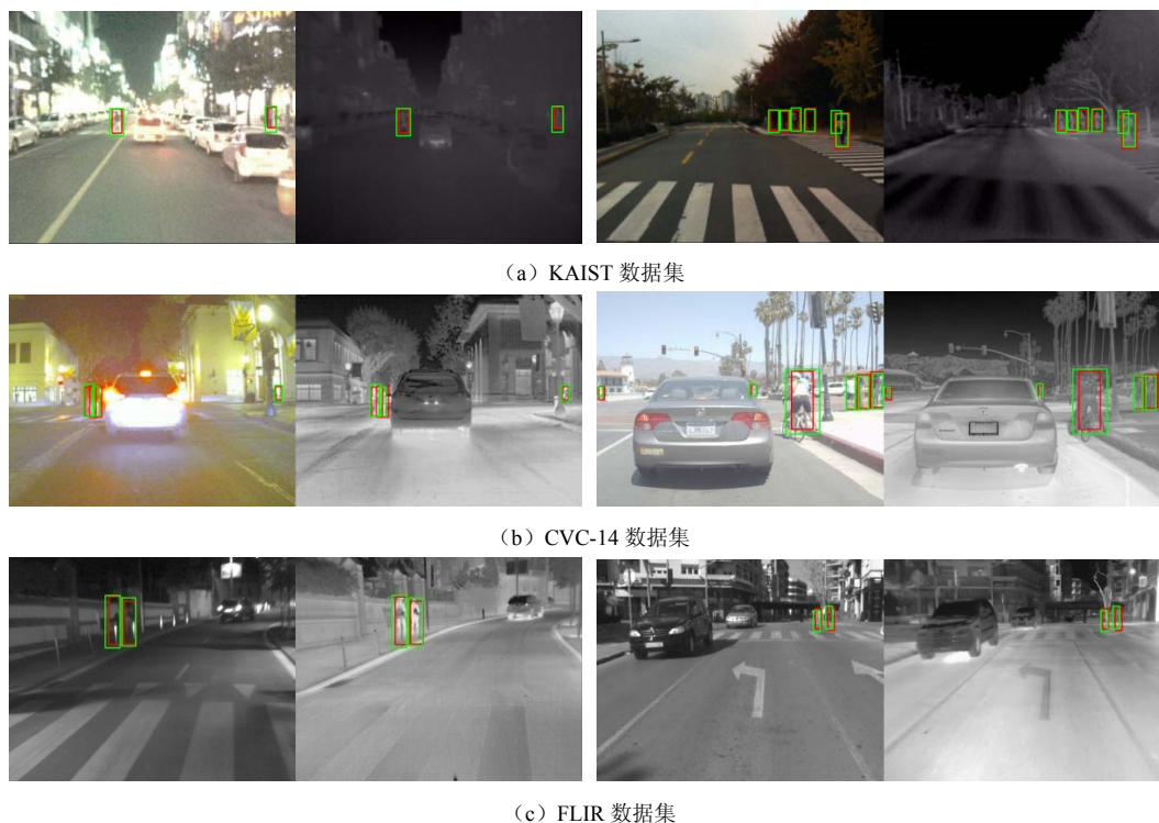
图6 本文算法在 KAIST、CVC-14、FLIR 数据集上的部分检测结果
